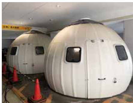
救急外来に設置された 陰圧テント
